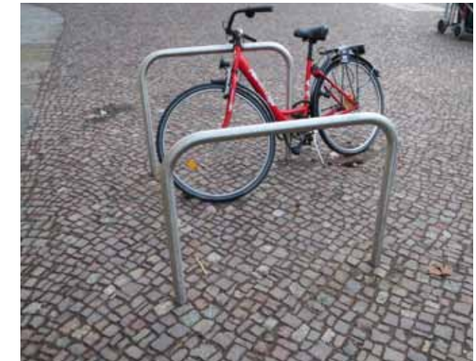
Abb. 70 Fahrradbügel, Leipziger Bügel, Edelstahl gebürstet
